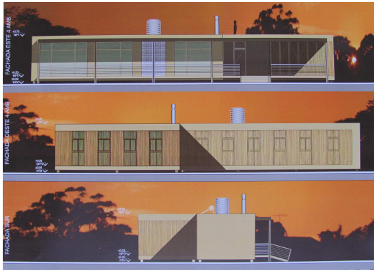
Figs. 7 y 8: Envoltente resuelta con tecnología de caña adaptada a diferentes orientaciones, generando fusión interior- exterior según la necesidad.
